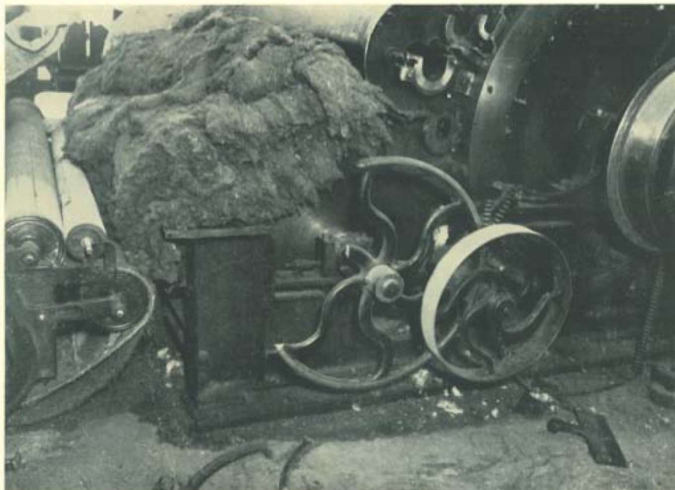
Ingranaggi spezzati dai guastatori
