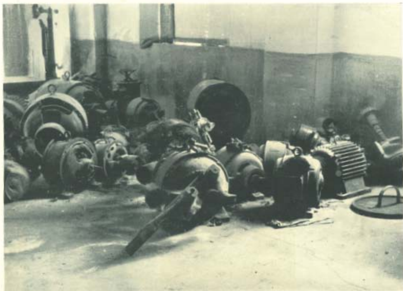
Motori elettrici danneggiati
